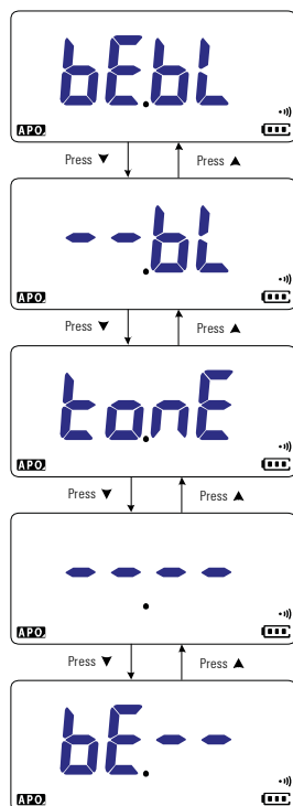
Figura 4-11 Modifica degli allarmi su test di continuità
